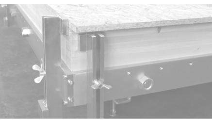
Eckverstärker: Dort wo die Anschlagplatten rechtwinklig zusammentreffen, werden Sie durch einen Eckverstärker verbunden um zusätzliche Robustheit zu garantieren.
